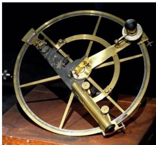
Le cercle à réflexion déposé au musée est en laiton et porte le N°422. Il est signé Jecker à Paris. Ses caractéristiques: limbe gravé sur argent, rayon 15 cm
