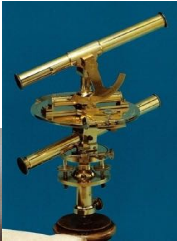
Théodolite Jecker déposé au musée Hauteur: 21 c, longueur des lunettes 22 cm, diamètre du plateau: 15 cm
