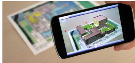
La réalité augmentée sur plan (ou marqueur) consiste à afficher un modèle 3D en visant un plan 2D.
