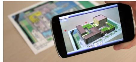
La réalité augmentée sur plan (ou marqueur) consiste à afficher un modèle 3D en visant un plan 2D.
